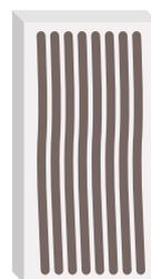
En plein à la lisseuse crantée de U5 à U10 sur support de parfaite planéité.
